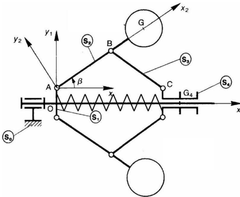
La masselotte  $S_2$  de masse  $m$ , de centre d'inertie  $G$ , a une liaison pivot d'axe  $(A, \vec{z}_1)$  avec  $S_1$ .
