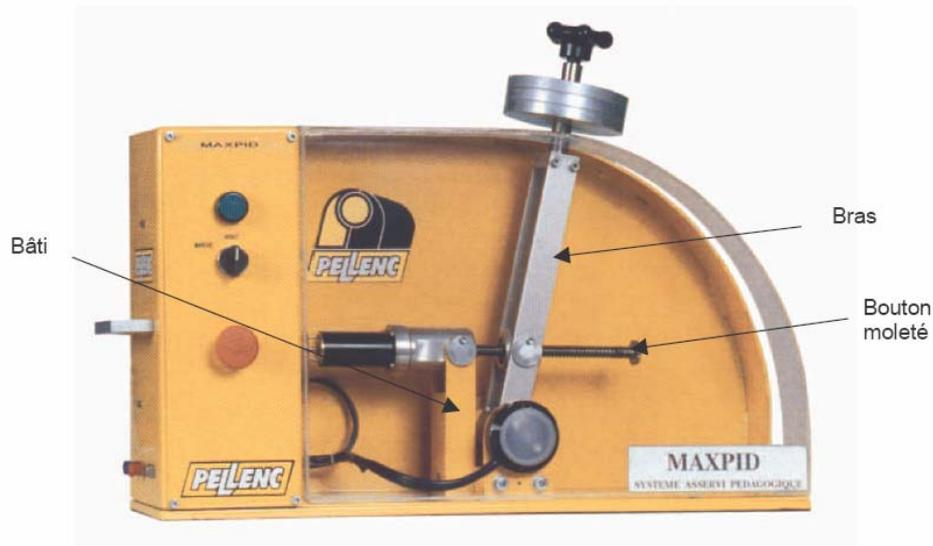
Ce système est principalement constitué d'un bras guidé en rotation par rapport au bâti. Ces deux pièces (bâti et bras) constituent deux éléments rigides successifs du bras du robot cueilleur de fruit.
