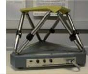
**Objectifs :** Étudier les limites de déplacement imputables au débattement angulaire maximal des rotules et à la course maximale des vérins. Comparer le modèle, la simulation et le réel.
