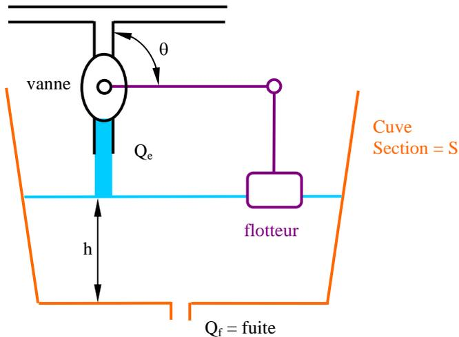
Une chasse d'eau peut être représentée par le schéma ci-contre. La vanne reliée au réseau d'eau, assure un débit d'entrée  $Q_e$ . L'eau rentrant dans la cuve fait monter la hauteur  $h$ . Le flotteur mesure cette hauteur et permet ainsi de fermer la vanne lorsque le niveau d'eau de référence  $h_{ref}$  est atteint, c'est-à-dire lorsque  $\theta = \theta_{ref}$ . La fuite est modélisée par le débit  $Q_f$ .
